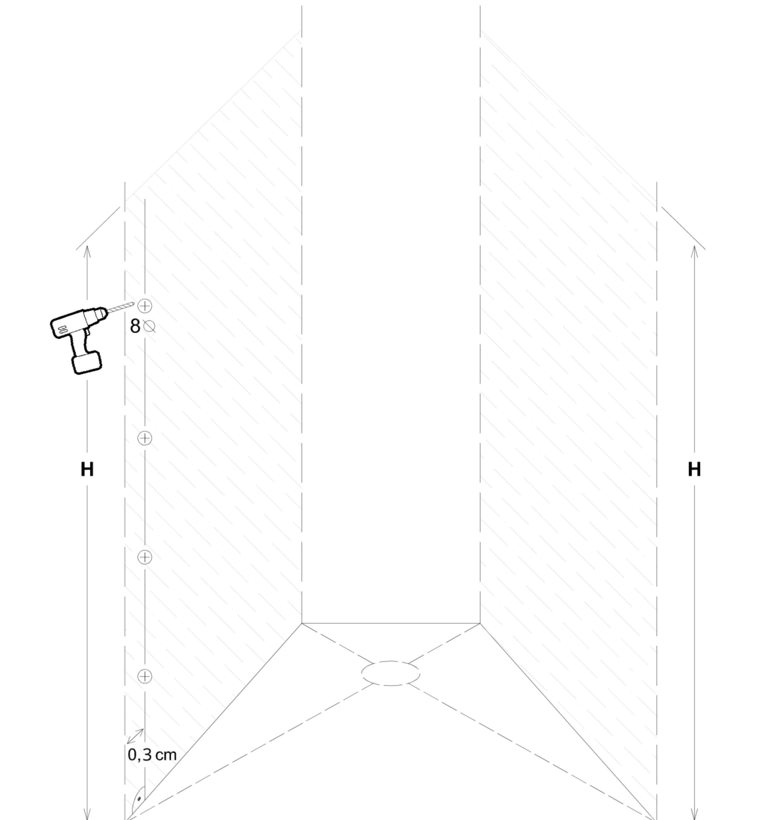
Benutzen Sie das Wandprofil in Glashöhe zum anzeichnen der Bohrlöcher.
