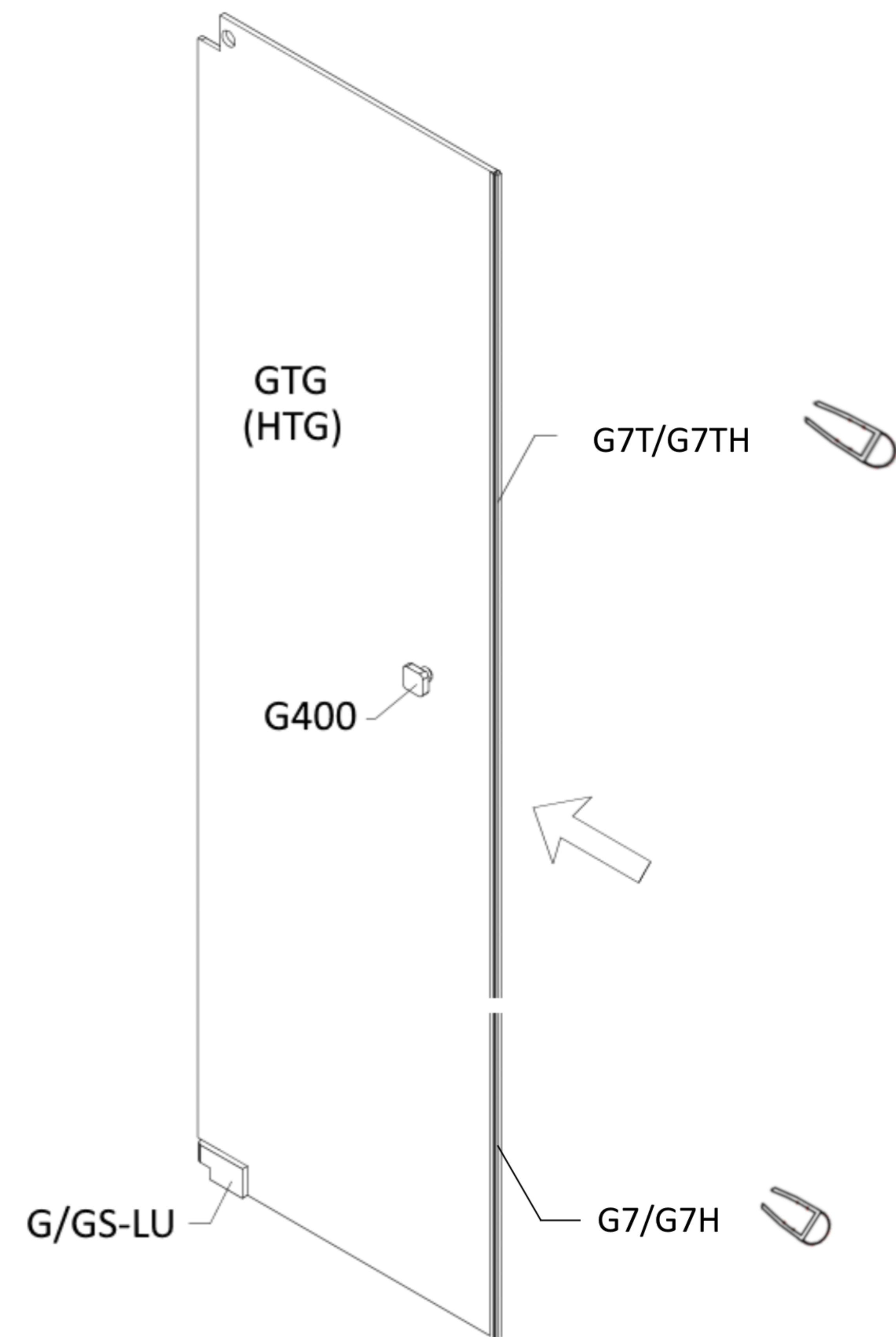
Die Balg dichtung G7/G7H muss auf das Maß H4 unten abgelängt werden. Die Balgdichtung G7T mit 25mm Tauchtiefe muss auf das Maß VH oben abgelängt werden. Die beiden Dichtungen können auf den entsprechenden Abstand zu Fliesen unten und verkürzter Festwand oben durch unterschiedliches Abziehen getrennt eingestellt werden.
