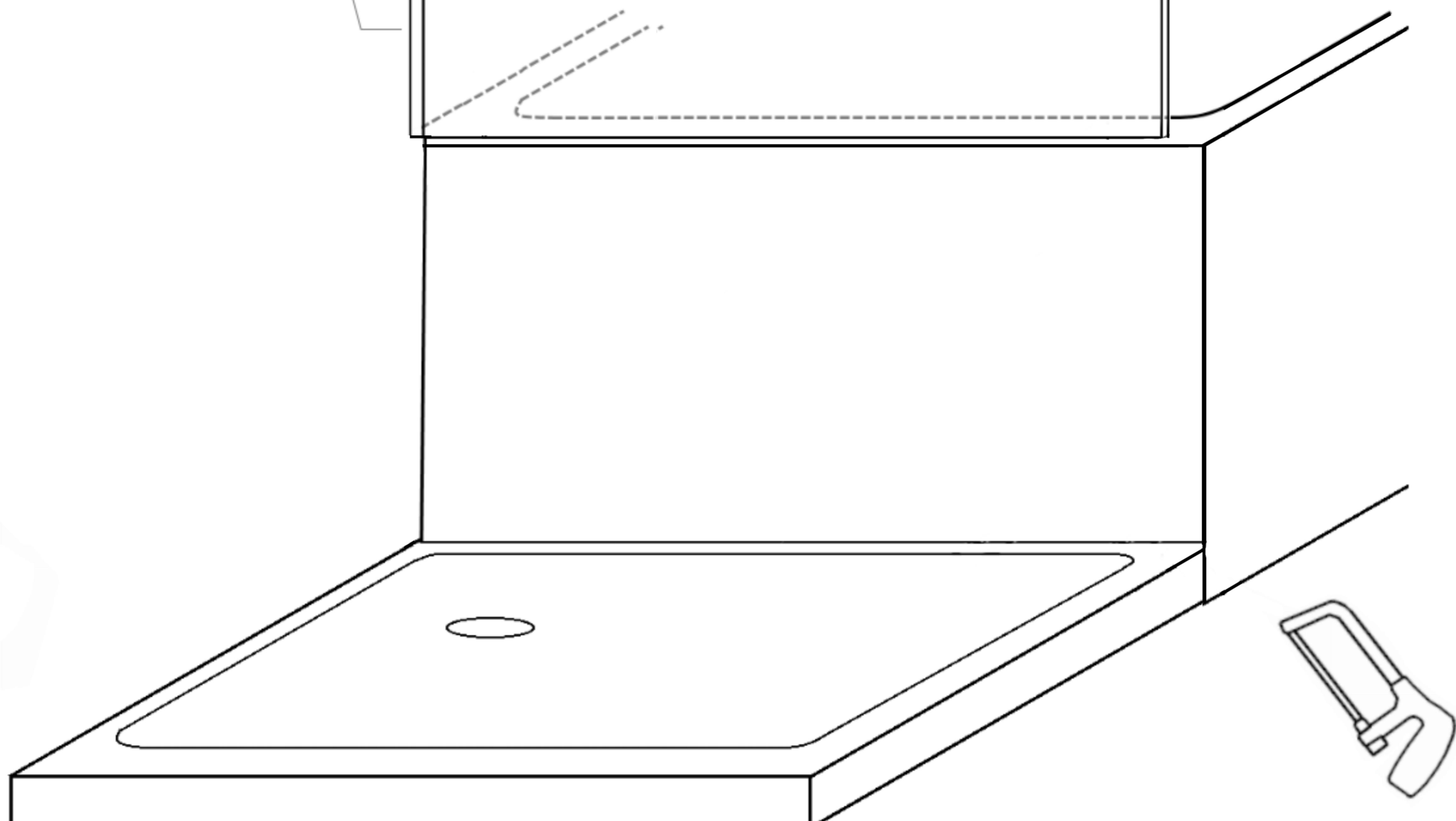
Richten Sie die verkürzte, feste Seitenwand (GPF/HPF) senkrecht aus und fixieren Sie die Inbus-Schrauben in den Langlöchern der Glasbefestigungen. Mit dem Montageschlüssel können die Glasbefestigungen dabei waagrecht gehalten werden.
