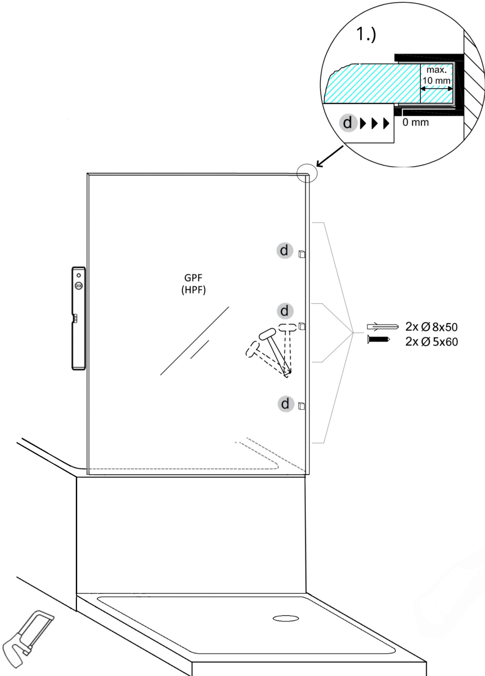
Richten Sie die verkürzte, feste Seitenwand (GPF/HPF) senkrecht aus und fixieren Sie die Inbus-Schrauben in den Langlöchern der Glasbefestigungen. Mit dem Montageschlüssel können die Glasbefestigungen dabei waagrecht gehalten werden.
