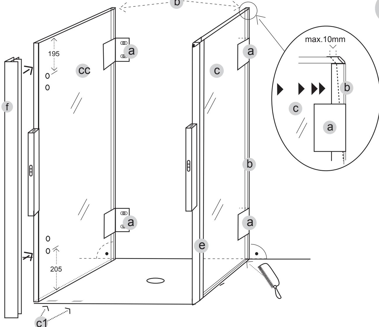
**D** Richten Sie die feste Seitenwand **cc** senkrecht aus und schieben Sie das Kompensationsprofil **b** mit Druck an die Wand um Schrägen auszugleichen. Fixieren Sie dann mit den Wandbefestigungen **a**. Bei gerader Wand kann auf das Kompensationsprofil **b** verzichtet werden und dersenkrechte Wandanschluss absilikoniert werden (Abstand Wand / Glas min. 2 mm).
