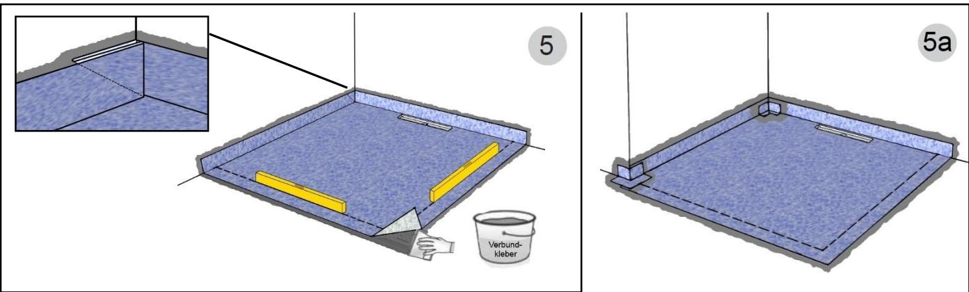
**5a** (D) Wenn das Dichtvlies an einer Ecke eingeschnitten wird ist zwingend eine Innen- bzw. Außen-Dichtecke zusätzlich zu verwenden.
