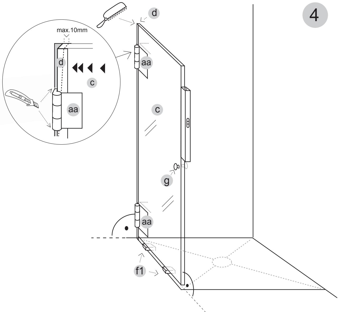
**D** Richten Sie die Türe **c** senkrecht aus und schieben Sie dann das Kompensationsprofil **b** an die Wand, so dass die Fuge zwischen Wand und Türe mit der Dichtlippe innen gleichmäßig geschlossen wird. Schneiden Sie die flexible Dichtlippe über und unter den Scharnieren **aa** waagerecht ein. Fixieren Sie dann mit den Scharnieren **aa**.
