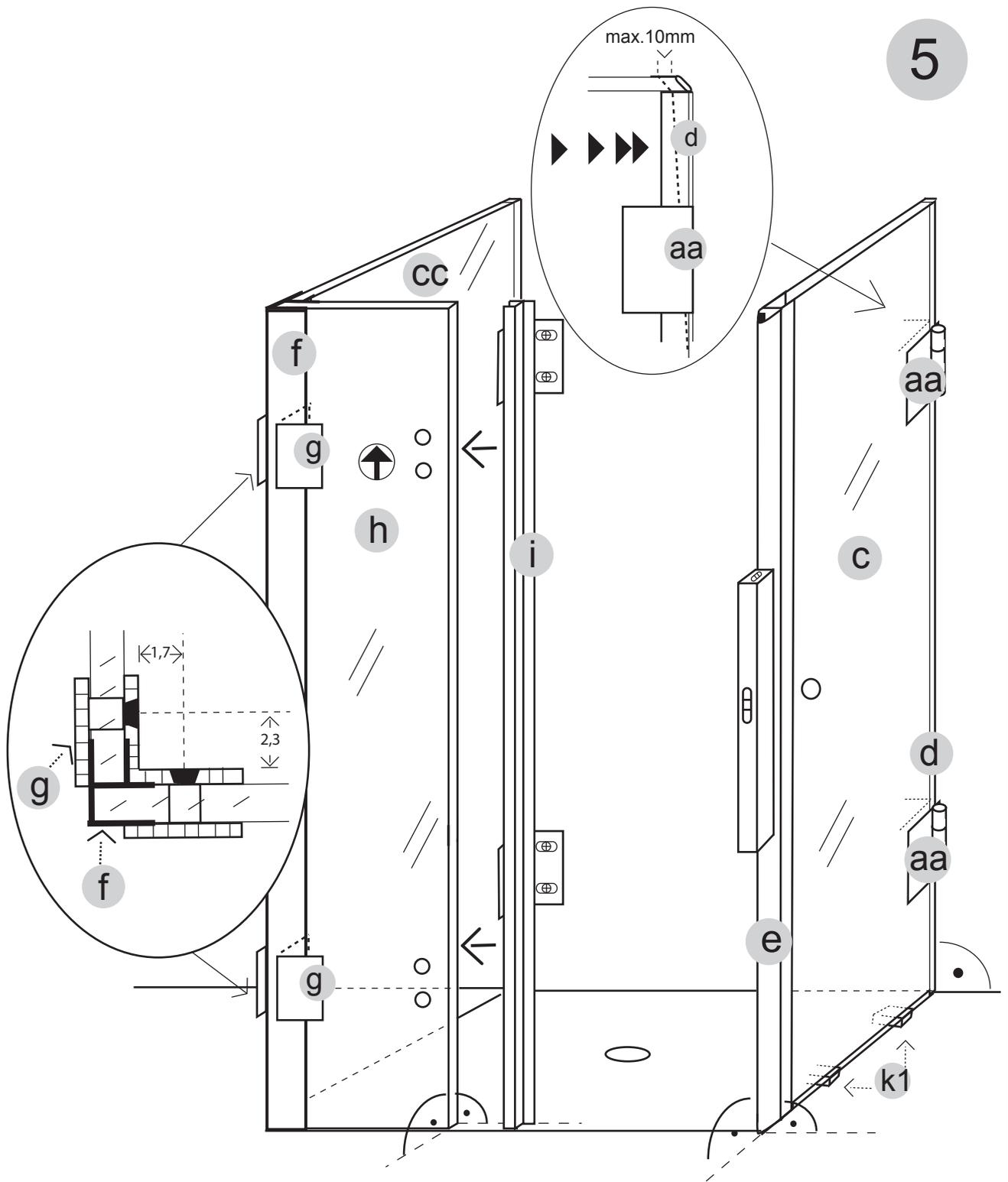
**(D)** Richten Sie das Festteil **(c)** senkrecht aus und schieben Sie das Kompensationsprofil **(d)** mit Druck an die Wand um Schrägen auszugleichen. Fixieren Sie dann mit den Wandbefestigungen **(a)**. Bei gerader Wand kann auf das Kompensationsprofil **(d)** verzichtet werden und der senkrechte Wandanschluss absilikoniert werden (Abstand Wand / Glas min. 2 mm).
