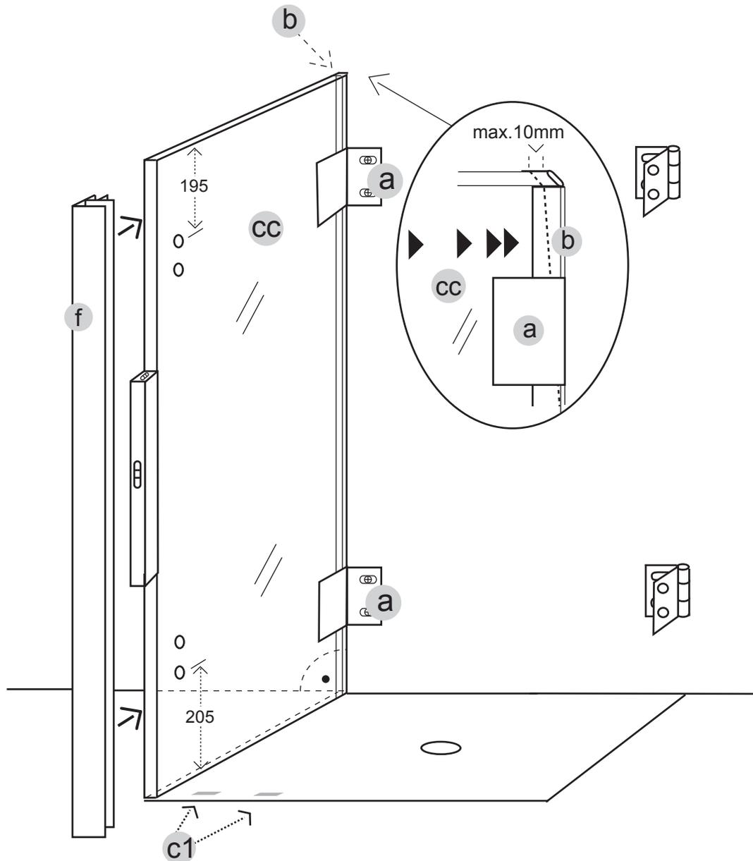
Ⓓ Richten Sie die feste Seitenwand **CC** senkrecht aus und schieben Sie das Kompensationsprofil **b** mit Druck an die Wand um Schrägen auszugleichen. Fixieren Sie dann mit den Wandbefestigungen **a**. Bei gerader Wand kann auf das Kompensationsprofil **b** verzichtet werden und dersenkrechte Wandanschluss absilikoniert werden (Abstand Wand / Glas min. 2 mm).
