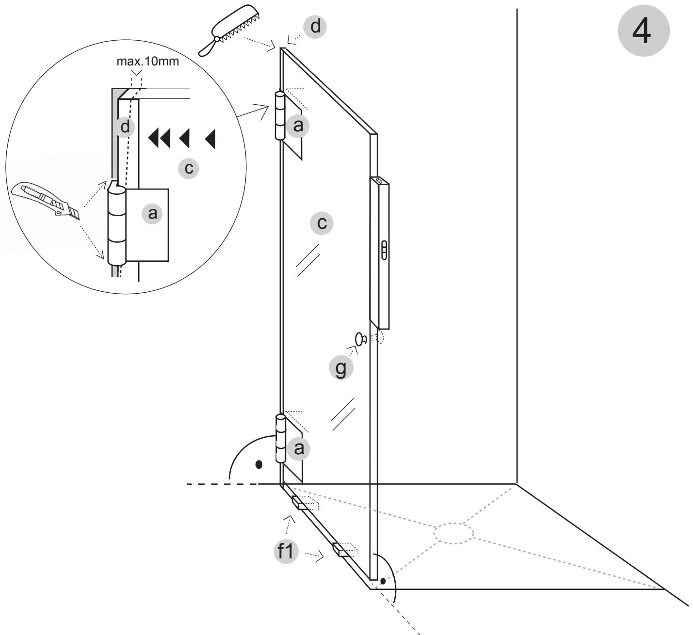
**D** Richten Sie die Türe(c) senkrecht aus und schieben Sie dann das Kompensationsprofil(b) an die Wand, so dass die Fuge zwischen Wand und Türe mit der Dichtlippe innen gleichmäßig geschlossen wird. Schneiden Sie die flexible Dichtlippe über und unter den Scharnieren(a) waagerecht ein. Fixieren Sie dann mit den Scharnieren(a).
