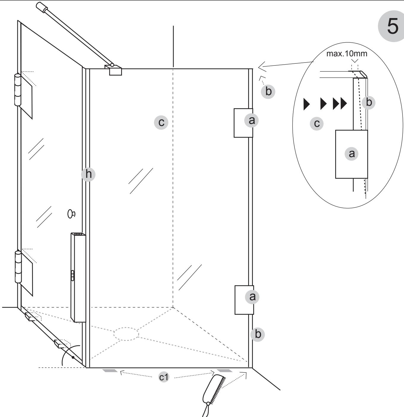
**D** Richten Sie die feste Seitenwand **c** senkrecht aus und schieben Sie das Kompensationsprofil **b** mit Druck an die Wand um Schrägen auszugleichen, kürzen Sie das Sockelprofil **d** so ein, dass es zwischen Kompensationsprofil **b** und Magnetleiste **e** passt. Fixieren Sie dann mit den Wandbefestigungen **a**. Bei gerader Wand kann auf das Kompensationsprofil **b** verzichtet werden und der senkrechte Wandanschluss absilikoniert werden (Abstand Wand / Glas min. 2 mm).
