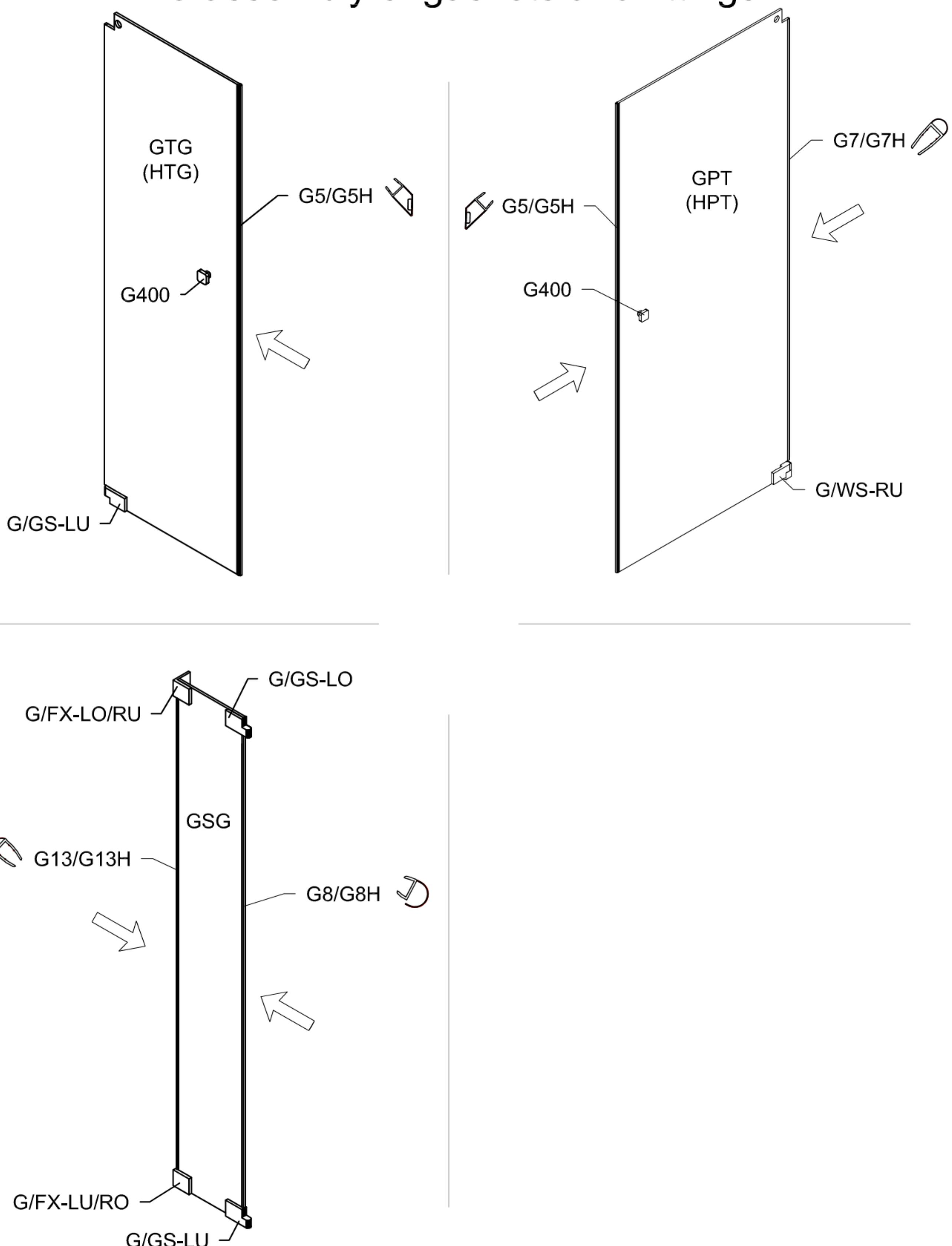
Bei gerader Wand kann auf das Kompensationsprofil G13/G13H verzichtet werden und der senkrechte Wandanschluss wird dann absilikoniert (Abstand Wand / Glas min. 3 mm).
