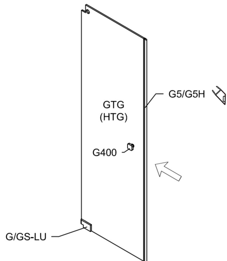
Bei gerader Wand kann auf das Kompensationsprofil G13/G13H verzichtet werden und der senkrechte Wandanschluss wird dann absilikoniert (Abstand Wand / Glas min. 3 mm).
