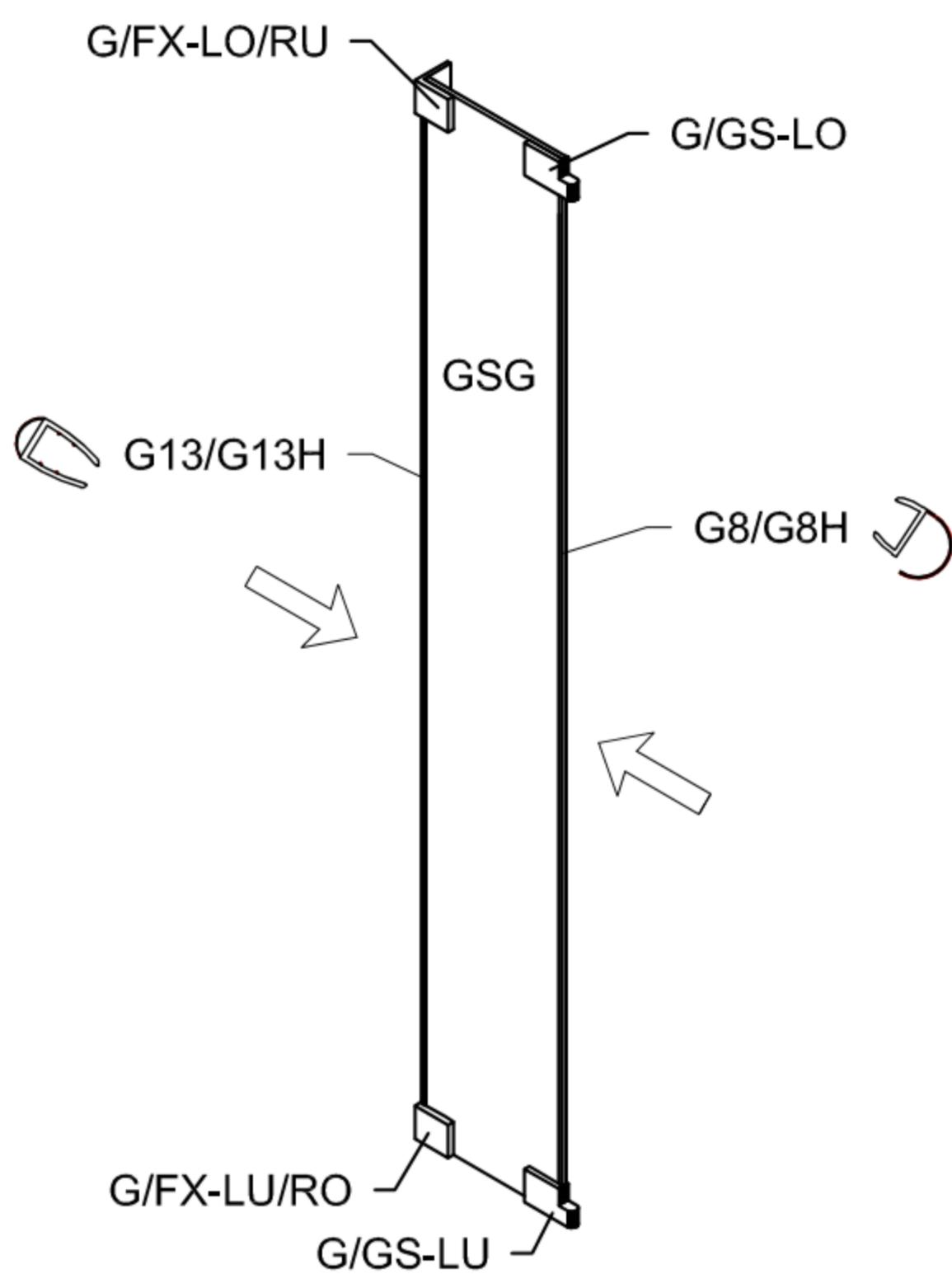
Bei gerader Wand kann auf das Kompensationsprofil G13/G13H verzichtet werden und der senkrechte Wandanschluss wird dann absilikoniert (Abstand Wand / Glas min. 3 mm).
