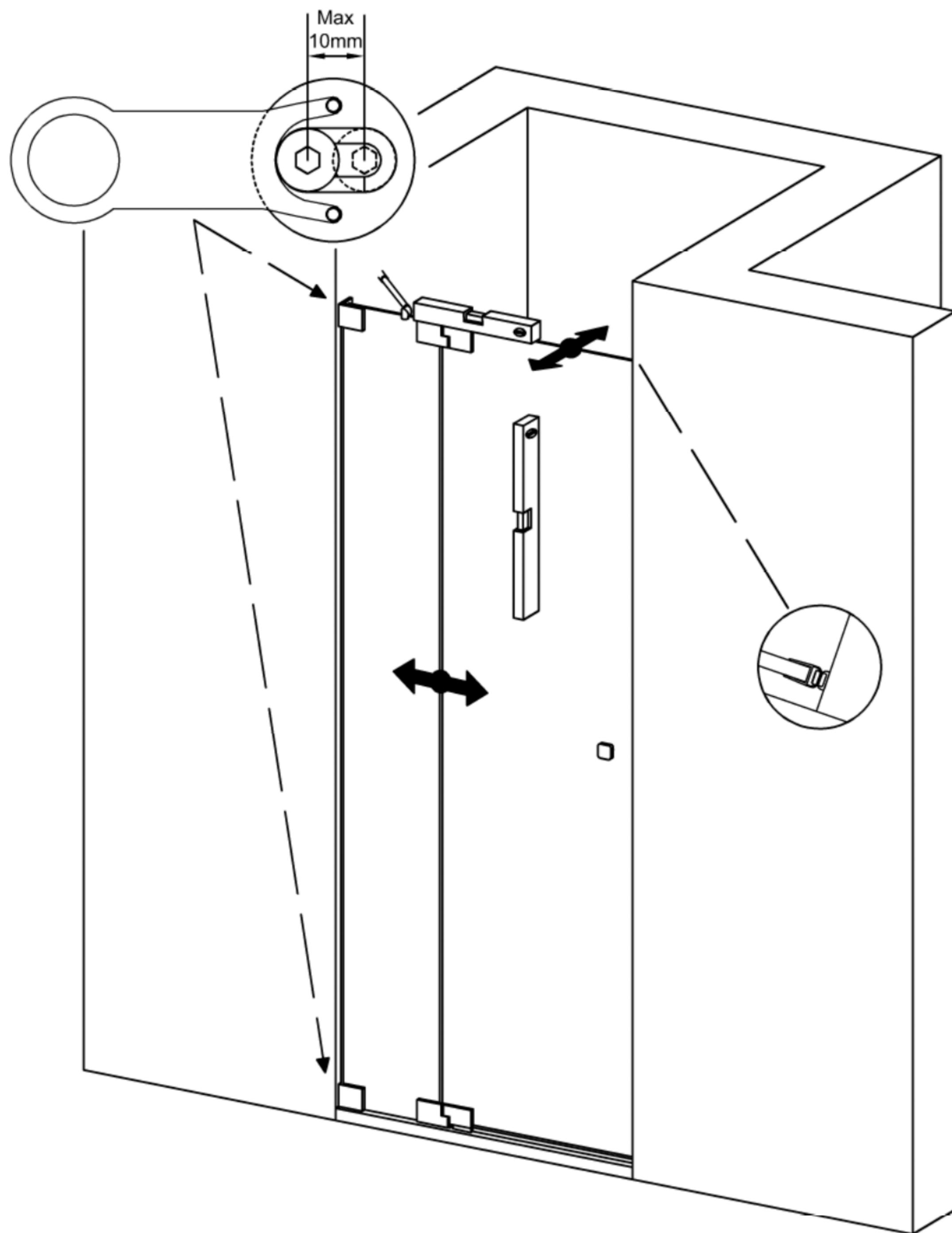
Richten Sie das Glas-Festteil senkrecht aus und fixieren sie die Inbus-Schrauben in den Langlöchern der Glasbefestigungen. Mit dem Montage-Schlüssel können die Glasbefestigungen dabei waagerecht gehalten werden. Schieben Sie dann das Kompensationsprofil (G13 / G13H) auf dem Glas mit Druck an die Wand, um Schrägen auszugleichen. Bei gerader Wand kann auf das Kompensationsprofil verzichtet werden und der senkrechte Wandanschluss absilikoniert werden (Abstand Wand / Glas min. 3 mm).
