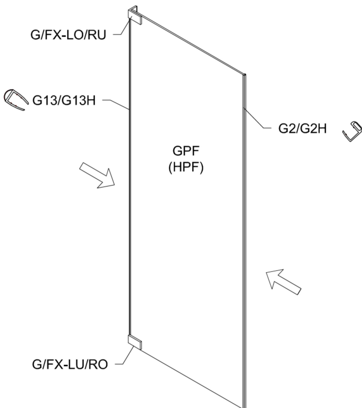
Bei gerader Wand kann auf das Kompensationsprofil G13/G13H verzichtet werden und der senkrechte Wandanschluss wird dann absilikoniert (Abstand Wand / Glas min. 3 mm).
