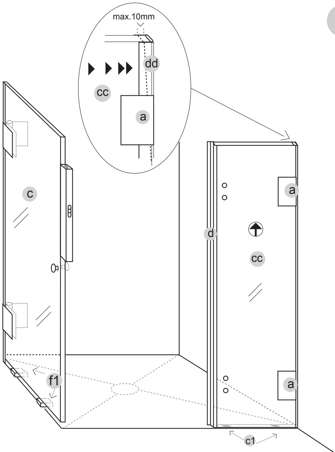
**D** Richten Sie das Festteil C senkrecht aus und schieben Sie das Kompensationsprofil B mit Druck an die Wand um Schrägen auszugleichen. Fixieren Sie dann mit den Wandbefestigungen A. Bei gerader Wand kann auf das Kompensationsprofil B verzichtet werden und der senkrechte Wandanschluss absilikoniert werden (Abstand Wand / Glas min. 2 mm).
