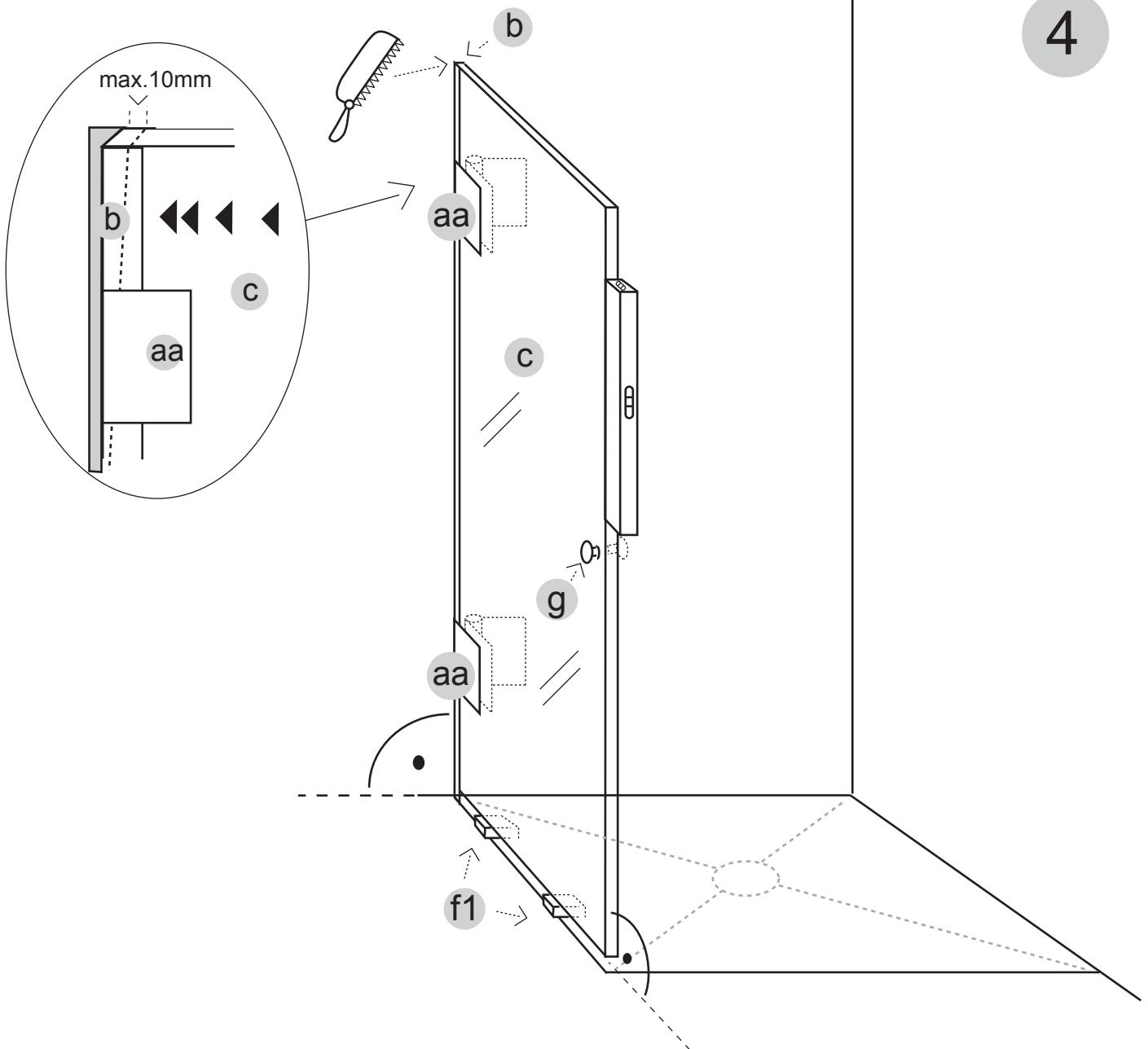
**D** Richten Sie die Türe(c) senkrecht aus und schieben Sie das oben einzukürzende Kompensationsprofil(b) an die Wand, so dass die Fuge zwischen Wand und Türe mit der Dichtlippe innen gleichmäßig geschlossen wird. Fixieren Sie dann mit den Scharnieren(a).
