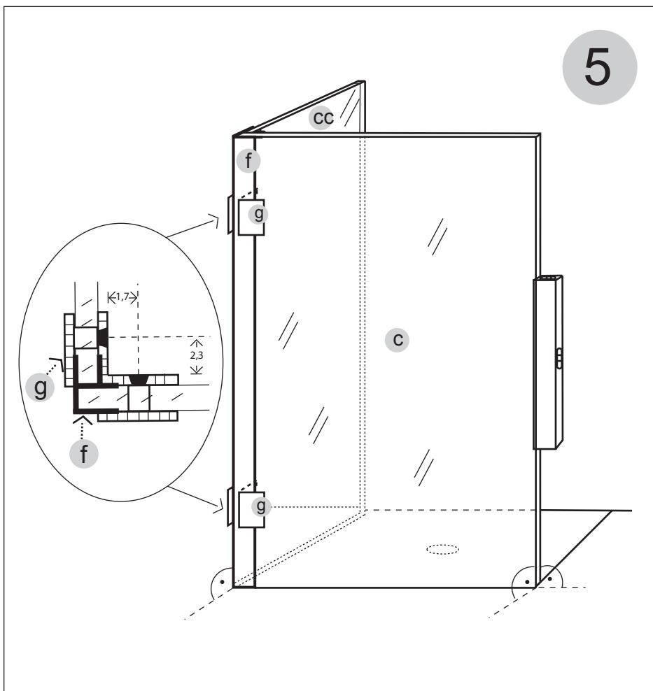
F Positionnez le paroi fixe **cc** d'aplomb et placez la plinthe de compensation **b** sur le mur en poussant fortement pour égaler les differences. Ensuite fixez la plinthe avec les vis de montage **a**. Avec des murs droits, il n'est pas nécessaire d'utiliser la plinthe de compensation **b**, on étanche avec un joint de silicon (distance verre / mur min. 2 mm).
