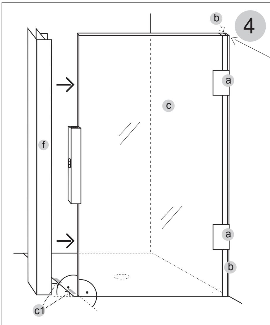
④ Richten Sie die feste Seitenwand (c) senkrecht aus und schieben Sie das Kompensationsprofil (b) mit Druck an die Wand um Schrägen auszugleichen. Fixieren Sie dann mit den Wandbefestigungen (a). Bei gerader Wand kann auf das Kompensationsprofil (b) verzichtet werden und dersenkrechte Wandanschluss absilikoniert werden (Abstand Wand / Glas min. 2 mm).
