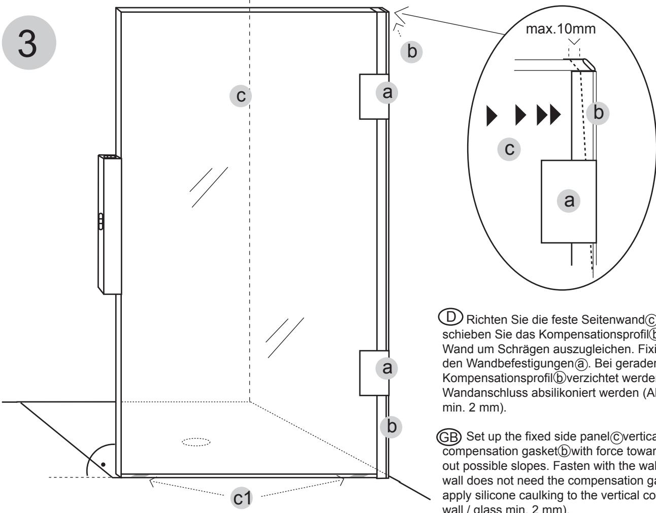
D Richten Sie die feste Seitenwand (c) senkrecht aus und schieben Sie das Kompensationsprofil (b) mit Druck an die Wand um Schrägen auszugleichen. Fixieren Sie dann mit den Wandbefestigungen (a). Bei gerader Wand kann auf das Kompensationsprofil (b) verzichtet werden und der senkrechte Wandanschluss absilikoniert werden (Abstand Wand / Glas min. 2 mm).
