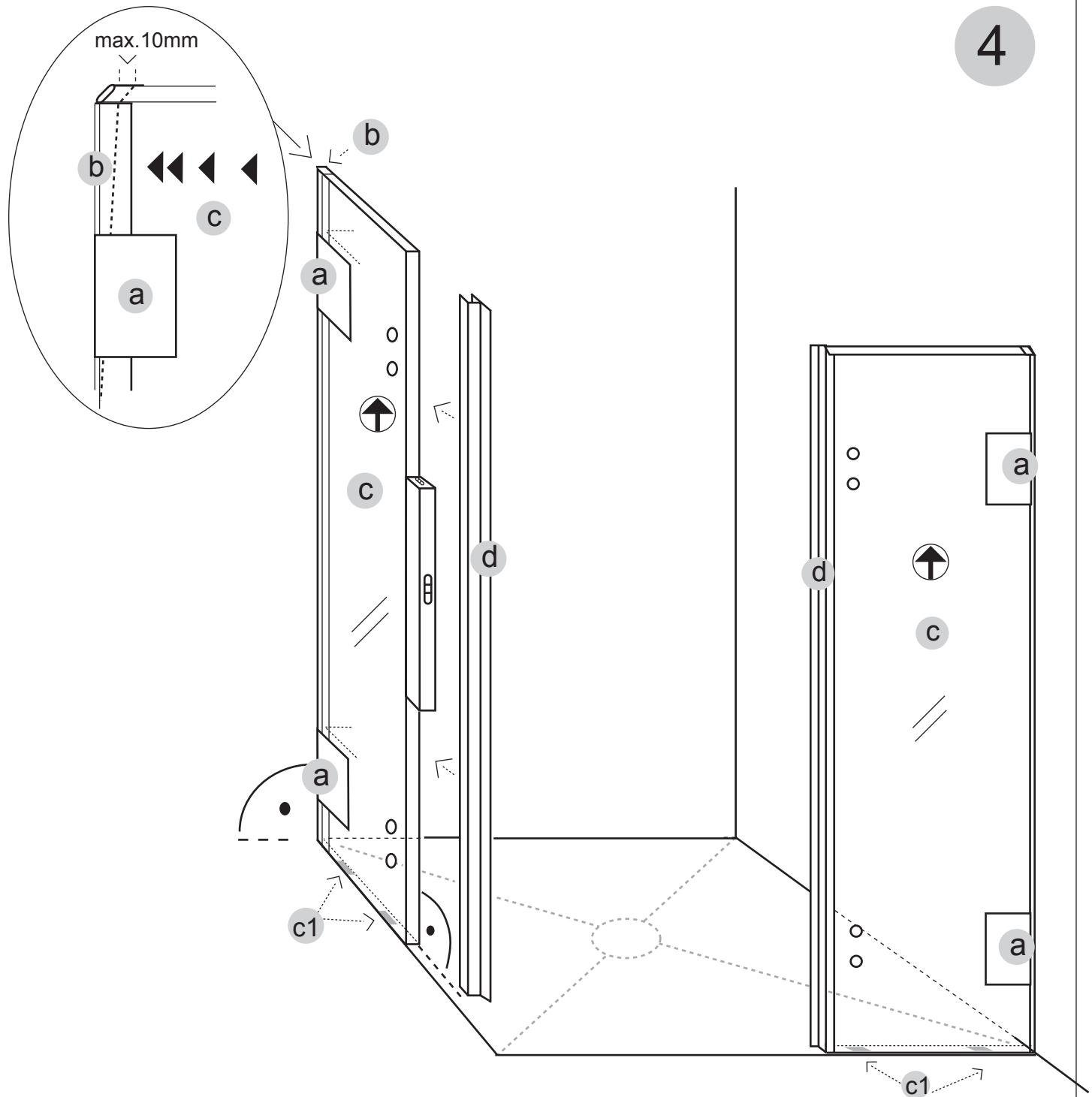
**D** Richten Sie das Festteil(c) senkrecht aus und schieben Sie das Kompensationsprofil(b) mit Druck an die Wand um Schrägen auszugleichen. Fixieren Sie dann mit den Wandbefestigungen(a). Bei gerader Wand kann auf das Kompensationsprofil(b) verzichtet werden und der senkrechte Wandanschluss absilikoniert werden (Abstand Wand / Glas min. 2 mm).
