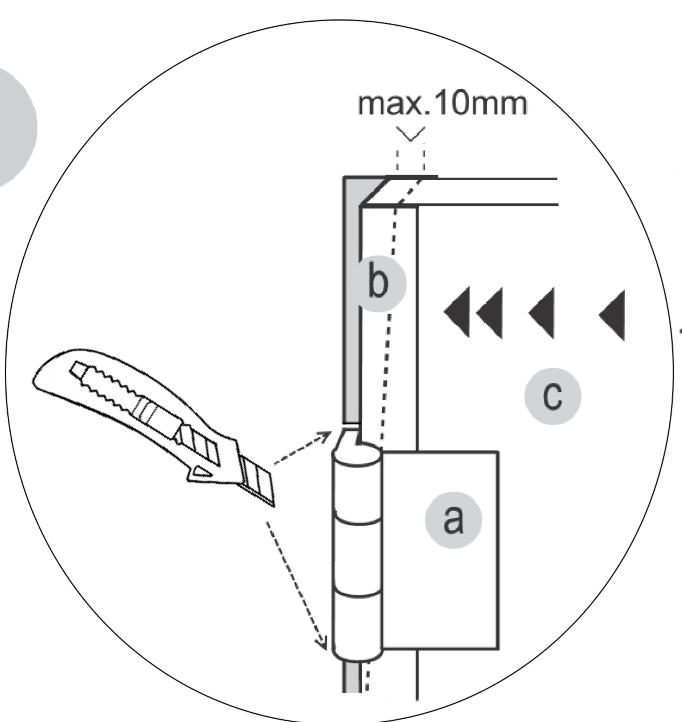
**D**) Richten Sie die Türe (c) senkrecht aus und schieben Sie dann das Kompensationsprofil (b) an die Wand, so dass die Fuge zwischen Wand und Türe mit der Dichtlippe innen gleichmäßig geschlossen wird. Schneiden Sie die flexible Dichtlippe über und unter den Scharnieren (a) waagerecht ein. Fixieren Sie dann mit den Scharnieren (a).
