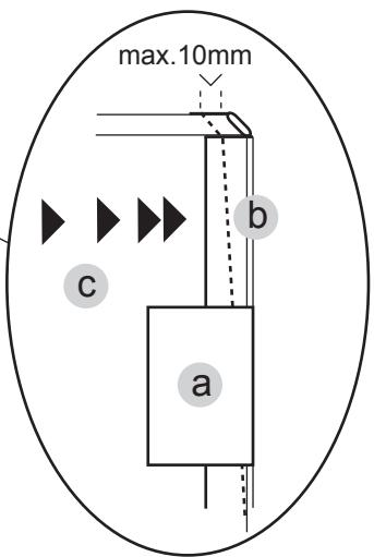
**D** Richten Sie die feste Seitenwand(c) senkrecht aus und schieben Sie das Kompensationsprofil(b) mit Druck an die Wand um Schrägen auszugleichen. Fixieren Sie dann mit den Wandbefestigungen(a). Bei gerader Wand kann auf das Kompensationsprofil(b) verzichtet werden und dersenkrechte Wandanschluss absilikoniert werden (Abstand Wand / Glas min. 2 mm).
