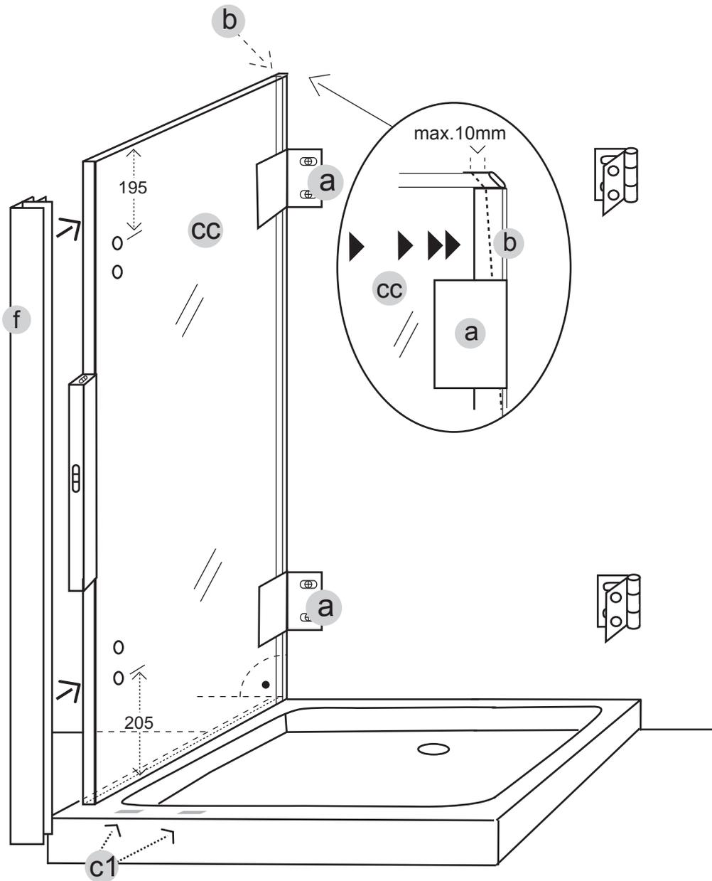
Ⓓ Richten Sie die feste Seitenwand **cc** senkrecht aus und schieben Sie das Kompensationsprofil **b** mit Druck an die Wand um Schrägen auszugleichen. Fixieren Sie dann mit den Wandbefestigungen **a**. Bei gerader Wand kann auf das Kompensationsprofil **b** verzichtet werden und dersenkrechte Wandanschluss absilikontiert werden (Abstand Wand / Glas min. 2 mm).
