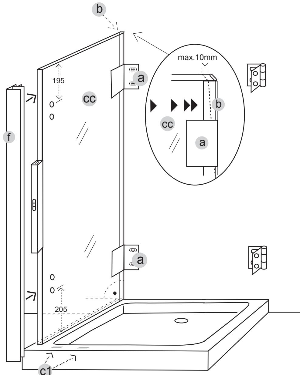
**D** Richten Sie die feste Seitenwand **cc** senkrecht aus und schieben Sie das Kompensationsprofil **b** mit Druck an die Wand um Schrägen auszugleichen. Fixieren Sie dann mit den Wandbefestigungen **a**. Bei gerader Wand kann auf das Kompensationsprofil **b** verzichtet werden und dersenkrechte Wandanschluss absilikoniert werden (Abstand Wand / Glas min. 2 mm).
