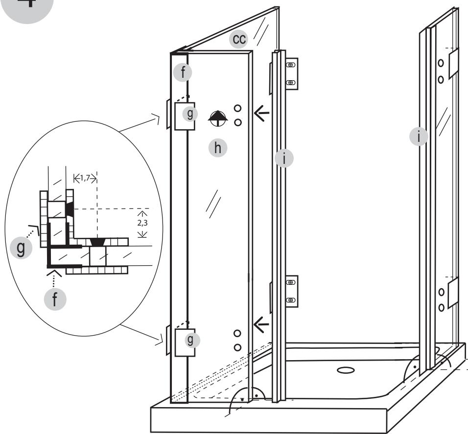
**F** Positionnez le paroi fixe **cc** et la paroi étroite fixe **h** d'aplomb et placez les plinthes de compensation **b** sur le mur en poussant fortement pour égaler les différences. Ensuite fixez la plinthe avec les vis de montage **a**. Avec des murs droits, il n'est pas nécessaire d'utiliser la plinthe de compensation **b**, on étanche avec un joint de silicon (distance verre / mur min. 2 mm).
