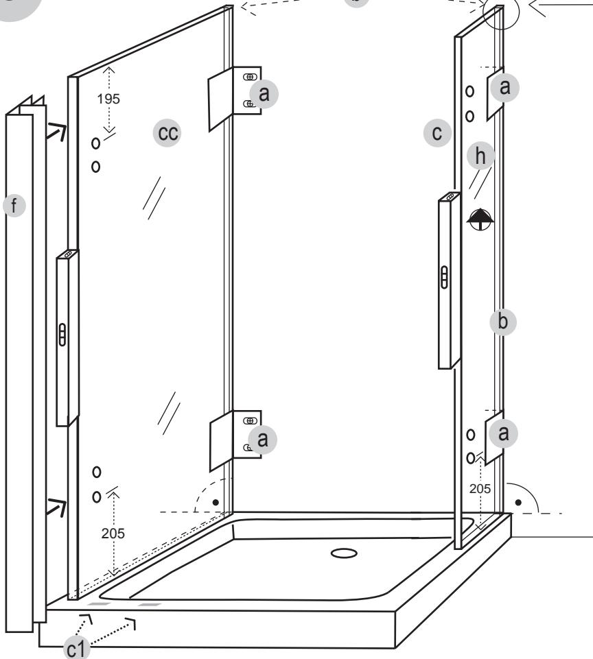
**D** Richten Sie die feste Seitenwand **cc** und das Festteil **h** senkrecht aus und schieben Sie die Kompensationsprofile **b** mit Druck an die Wand um Schrägen auszugleichen. Fixieren Sie dann mit den Wandbefestigungen **a**. Bei gerader Wand kann auf das Kompensationsprofil **b** verzichtet werden und der senkrechte Wandanschluss absilikoniert werden (Abstand Wand / Glas min. 2 mm).
