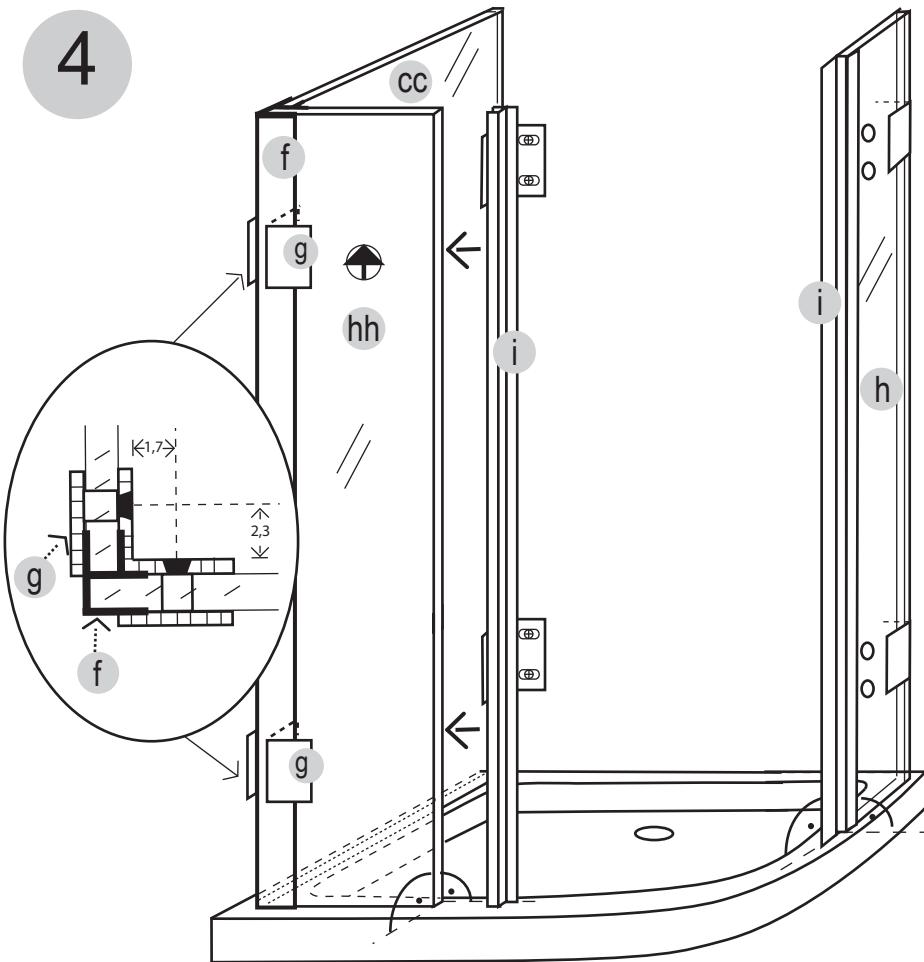
**I** Porre le pareti fissa **cc** e il lato fisso **h** in maniera verticale, spingere poi i profili di compensazione **b** con forza verso il muro, cosicché si possano compenare eventuali irregolarità. Fissare poi il tutto con gli attacchi a muro **a**. Nel caso in cui il muro sia esattamente diritto, si può rinunciare al profilo di compensazione **b** siliconando direttamente il lato verticale (distanza muro / vetro min. 2 mm).
