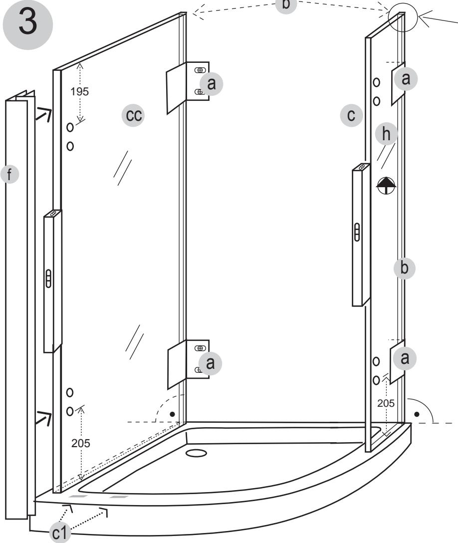
**D** Richten Sie die feste Seitenwand **cc** und das Festteil **h** senkrecht aus und schieben Sie die Kompensationsprofile **b** mit Druck an die Wand um Schrägen auszugleichen. Fixieren Sie dann mit den Wandbefestigungen **a**. Bei gerader Wand kann auf das Kompensationsprofil **b** verzichtet werden und der senkrechte Wandanschluss absilikoniert werden (Abstand Wand / Glas min. 2 mm).
