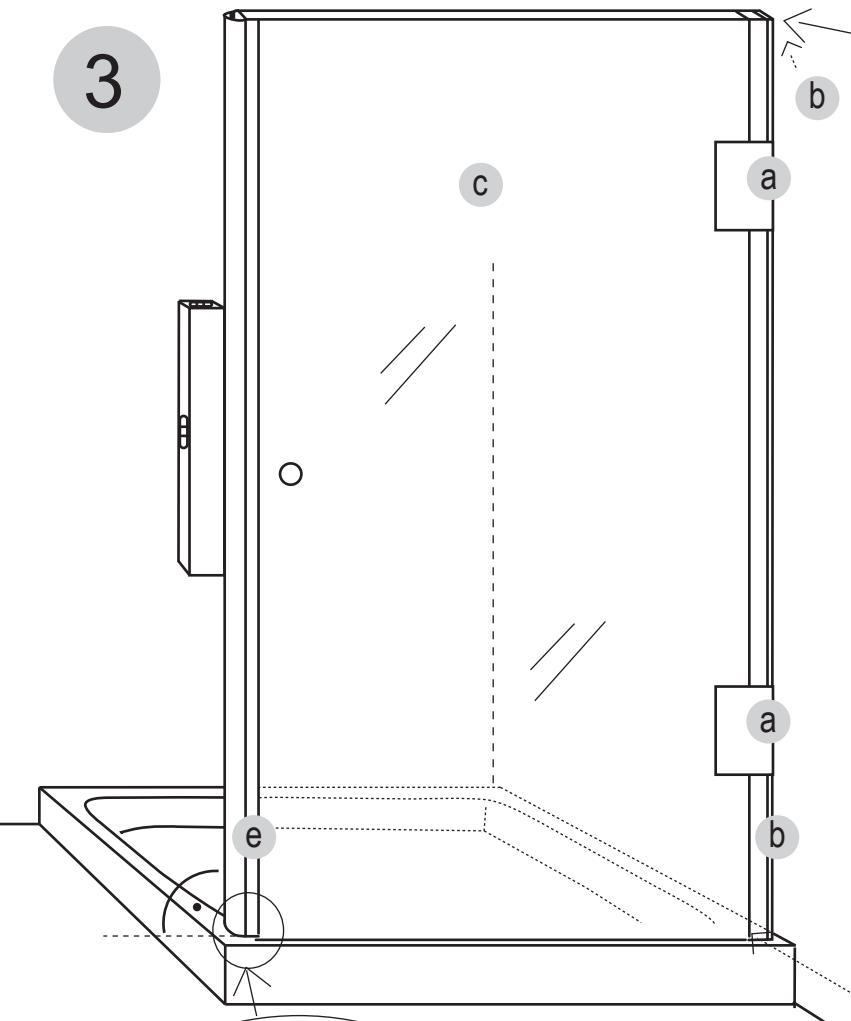
D Richten Sie die feste Seitenwand(c) senkrecht aus und schieben Sie das Kompensationsprofil(b) mit Druck an die Wand um Schrägen auszugleichen, kürzen Sie das Sockelprofil(d) so ein, dass es zwischen Kompensationsprofil(b) und Magnetleiste(e) passt. Fixieren Sie dann mit den Wandbefestigungen(a). Bei gerader Wand kann auf das Kompensationsprofil(b) verzichtet werden und der senkrechte Wandanschluss absilikoniert werden (Abstand Wand / Glas min. 2 mm).
